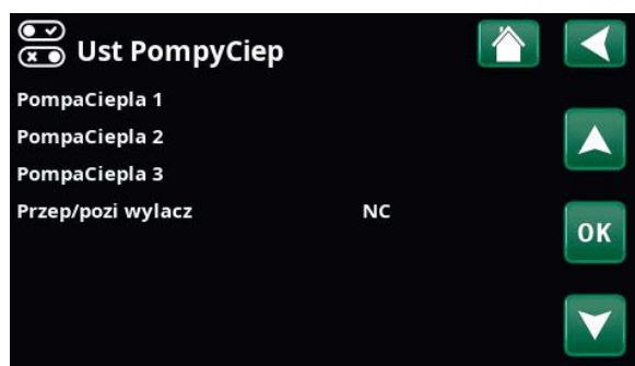
Przykład systemu z 3 pompami ciepła.
